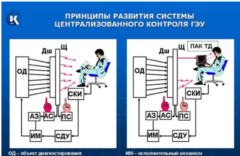
Рис. 1 Система централизованного контроля ЭУ. В основе схемы лежат семь групп процедур (рис.2): I, III и IV – функции подсистемы контроля и защиты; II – функции подсистемы регулирования; V, VI, VII – функции подсистемы диагностирования.
